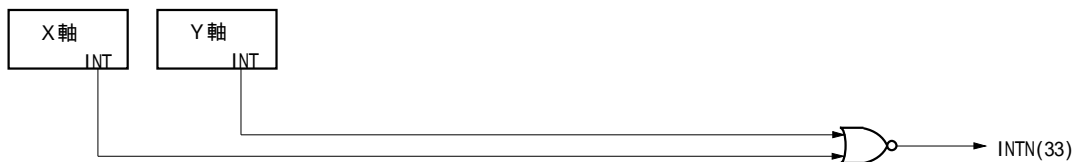
図2.40 IC内の割り込み信号経路
